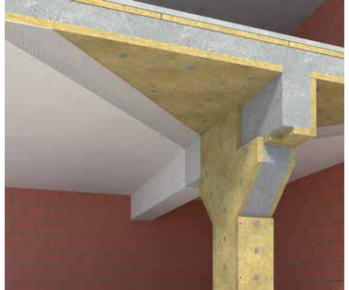
II. Vasbeton szerkezetek tűzvédelme
