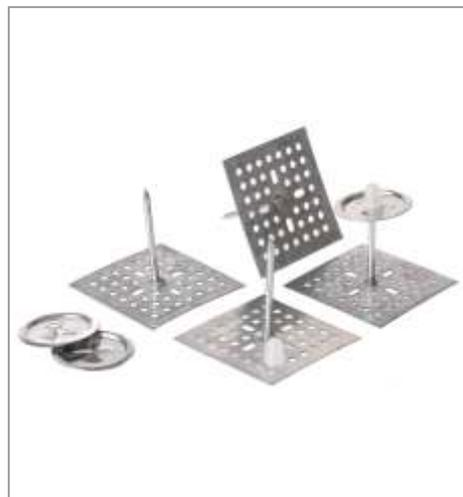
La saldatura dell'arpione con rondella consente il fissaggio del materiale isolante in una sola operazione. Il chiodo rivestito con un film di plastica permette un facile fissaggio del materiale isolante rivestito con alluminio oppure con rete metallica.
